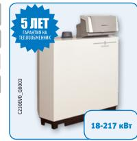
Газовые конденсационные котлы используются для отопления и приготовления ГВС как в коммерческих, так и в жилых и общественных проектах. Напольные газовые конденсационные котлы C 230 EVO — это компактные и легкие котлы (занимаемая площадь —  $0.54 \text{ m}^2$  и вес — 200 кг для модели мощностью 217 кВт), которые поставляются полностью в сборе и с панелью управления Diematic Evolution.
